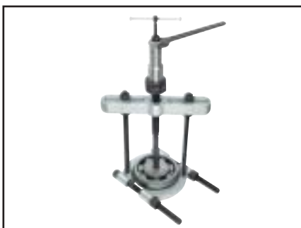
Dispositivo extractor No. 18-4 con hidráulico No. 8-1-B y separador No. 15-4
