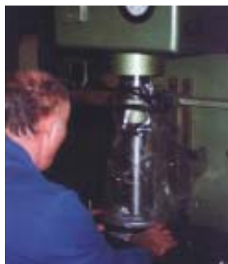
Prensa hidráulica de taller en funcionamiento con cubierta de lona para proteger contra accidentes No. T-UFP-2. La cubierta de lona para proteger contra accidentes envuelve el área de trabajo. Se puede observar y controlar de principio a fin la operación de trabajo.
